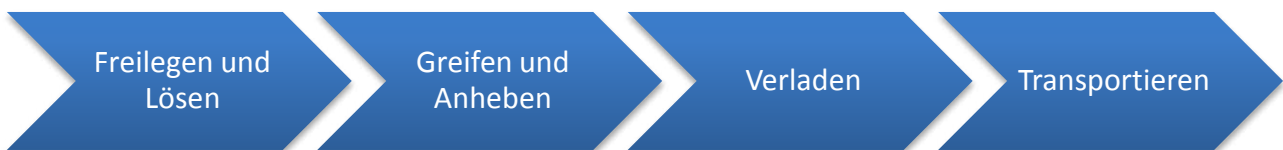
Abbildung 7: Verfahrenstechnische Kette für die Rückholung
