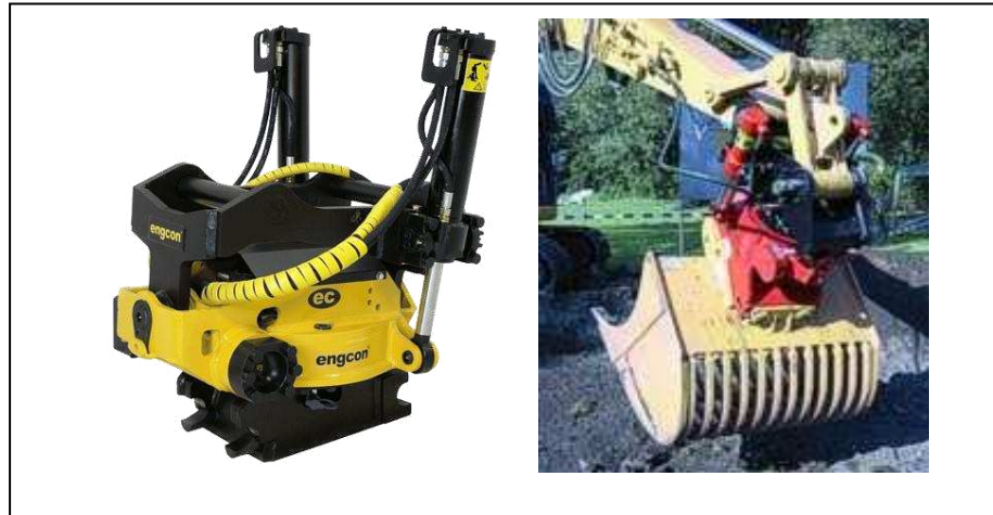
Abbildung 39: Tiltrotator (links) [40] und im Einsatz (rechts) [41]
